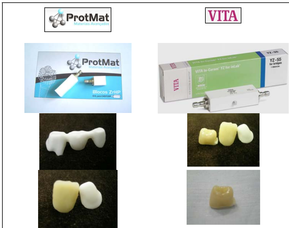
Figura 2: Fotos ilustrativas das embalagens, dos blocos pré-sinterizados e das próteses produzidas por usinagem CAD/CAM.
